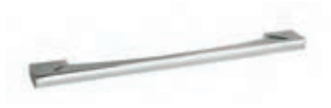
Maniglia 477 finitura cromo anta L 15 → passo 64 mm anta da L 30 a L 45 → passo 160 mm anta da L 60 a L 120 → passo 320 mm
