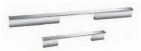
Maniglia 475C finitura cromo anta L 15 → passo 96 mm anta da L 30 a L 45 → passo 160 mm anta da L 60 a L 120 → passo 320 mm
